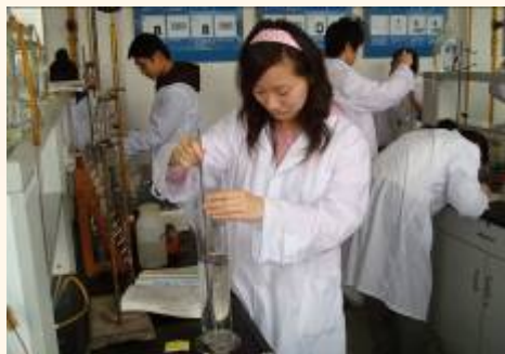
混匀搅拌及赶走气泡
