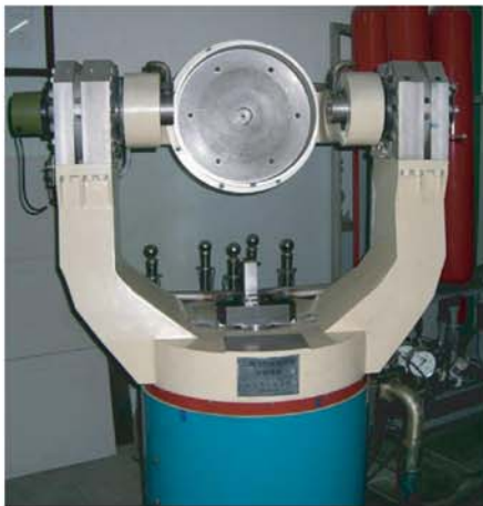
图 1 低频三轴液压角振动台照片
