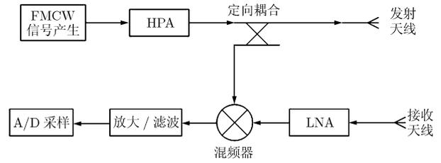
图 1 调频连续波 SAR 系统框图
