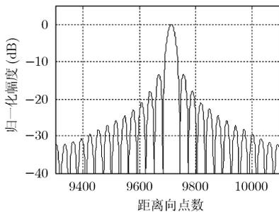
图 4 系统误差校正后距离向压缩结果
