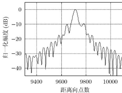
图 3 系统误差校正前距离向压缩结果
