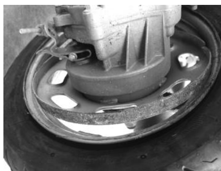
图 1 断裂轮辋宏观形貌
