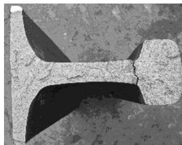
图3 焊机控制系统改进后的焊接接头
