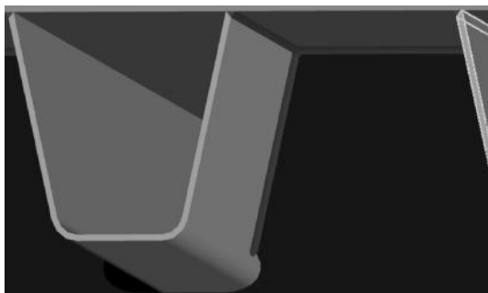
图 4 横隔板与 U形肋在顶板处的处理
