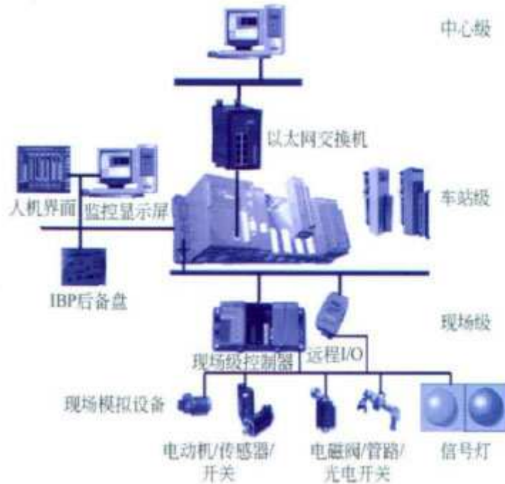
图 3 智能车站机电设备监控系统原形结构
