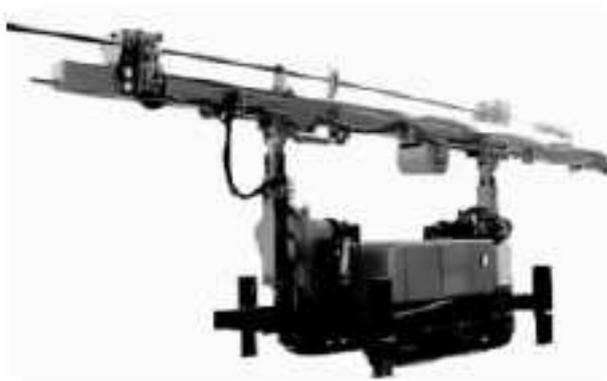
图1 SJ180 水平高压旋喷钻机
