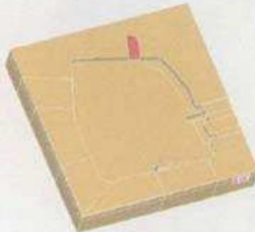
图7 第3步:对III(地下室施工二期)进行支护结构施工;
