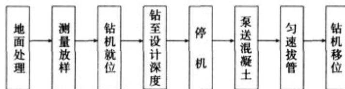
图 1 桩孔施工流程图
