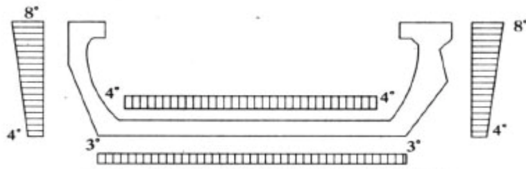
图 3 U 形梁不均匀升温的温度模式图
