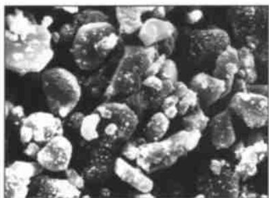
图 2 氧化铝坯体断面扫描电镜观察 \times 5000
