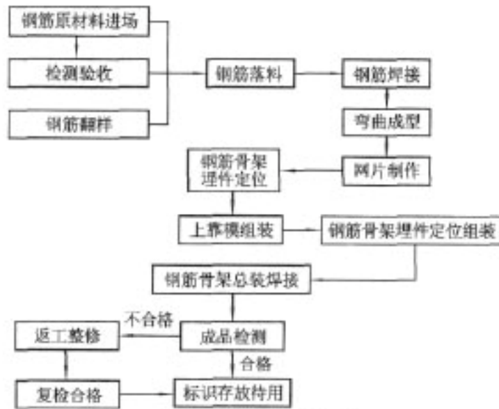
图 4 钢筋笼制作流程
