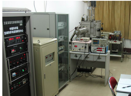
图 1 卫星深层充放电实验模拟装置照片
