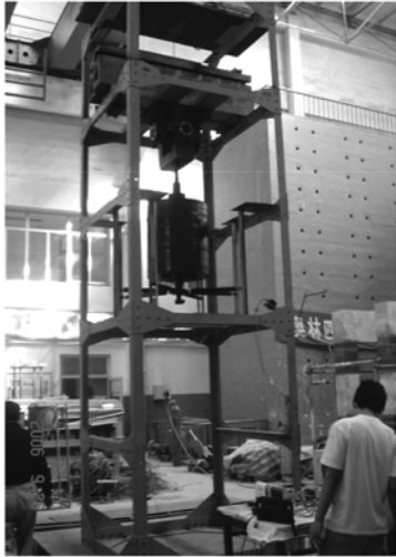
图 6 TMD 测试照片 Fig. 6 Photo of TMD test
