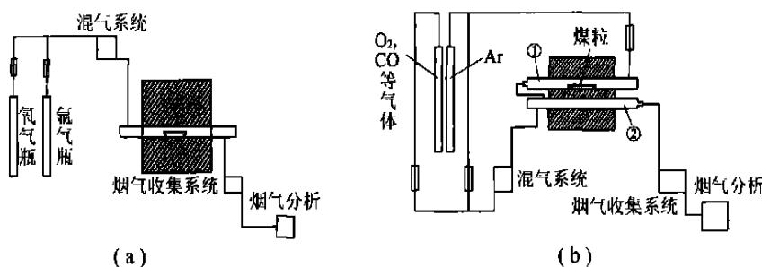
图1 煤粉和焦炭及挥发分燃烧试验装置
