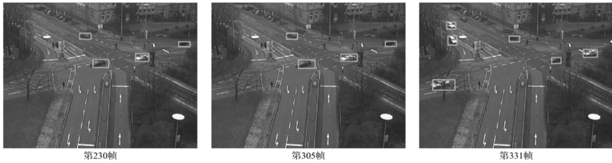
图2 低空平台下某交通路口的车辆视频序列跟踪结果
