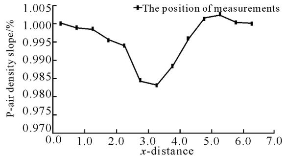
图 3 等离子体激励器附近高度为 1 mm 处空气密度扰动分布
