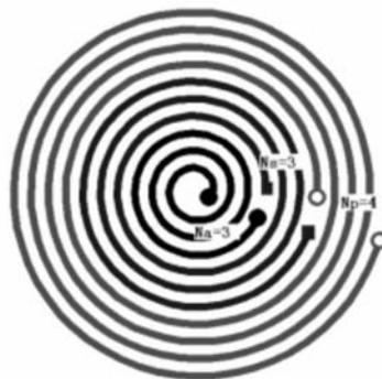
图 6 平面 PCB 变压器
