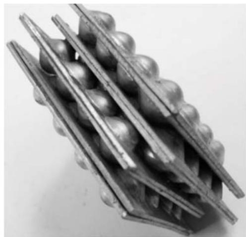
图 3 凸面在外平板层相连的类似体心立方结构多孔金属 B 型
