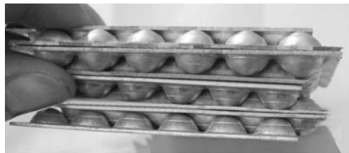
图 2 凹面在外平板层相连的类似体心立方结构多孔金属 A 型
