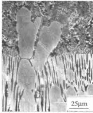
图4 单相胞晶超前生长界面形态  $G_L = 155K \cdot cm^{-1}; R = 2.5\mu m \cdot s^{-1}$
