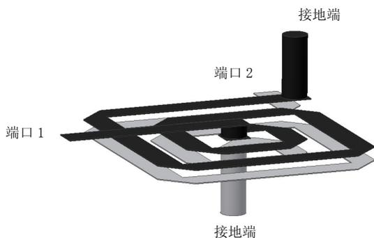
图2 螺旋耦合线三维结构图
