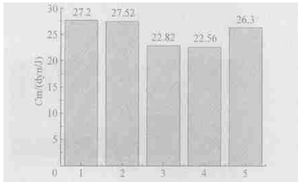
图 8 本文实验测定的冲量耦合系数与文献[16]的比较 1 - 飞行器 C, 2 - 飞行器 A, 3 - 飞行器 D, 4 - 飞行器 C, 5 - 文献[9,16] (飞行器质量 22g, 脉冲能量 200J)
