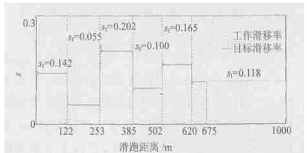
图 8 FNN 控制器对不同的目标滑移率的跟踪效果
