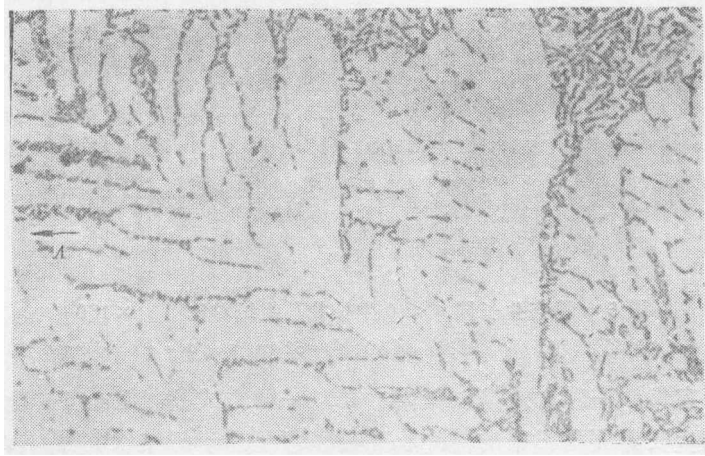
图 3 \alpha > 0 时初生 \alpha 相二次枝偏转生长 ( \alpha = 0.10 \mu\text{m}/\text{s}^2 \times 160 )
