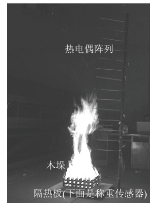
图 1 木垛火燃烧特征的实验现场图片
