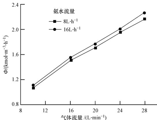
图 5 气体流量和氨水流量对  $\Phi$  的影响
