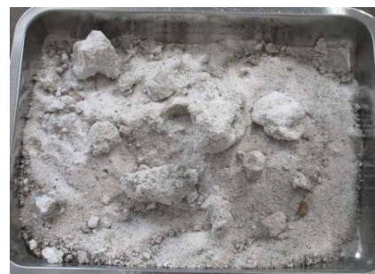
图 3 实验后床料照片(石英砂; 900 °C) Fig. 3 Bed material after the experiment (100% quartz sand; 900 °C)
