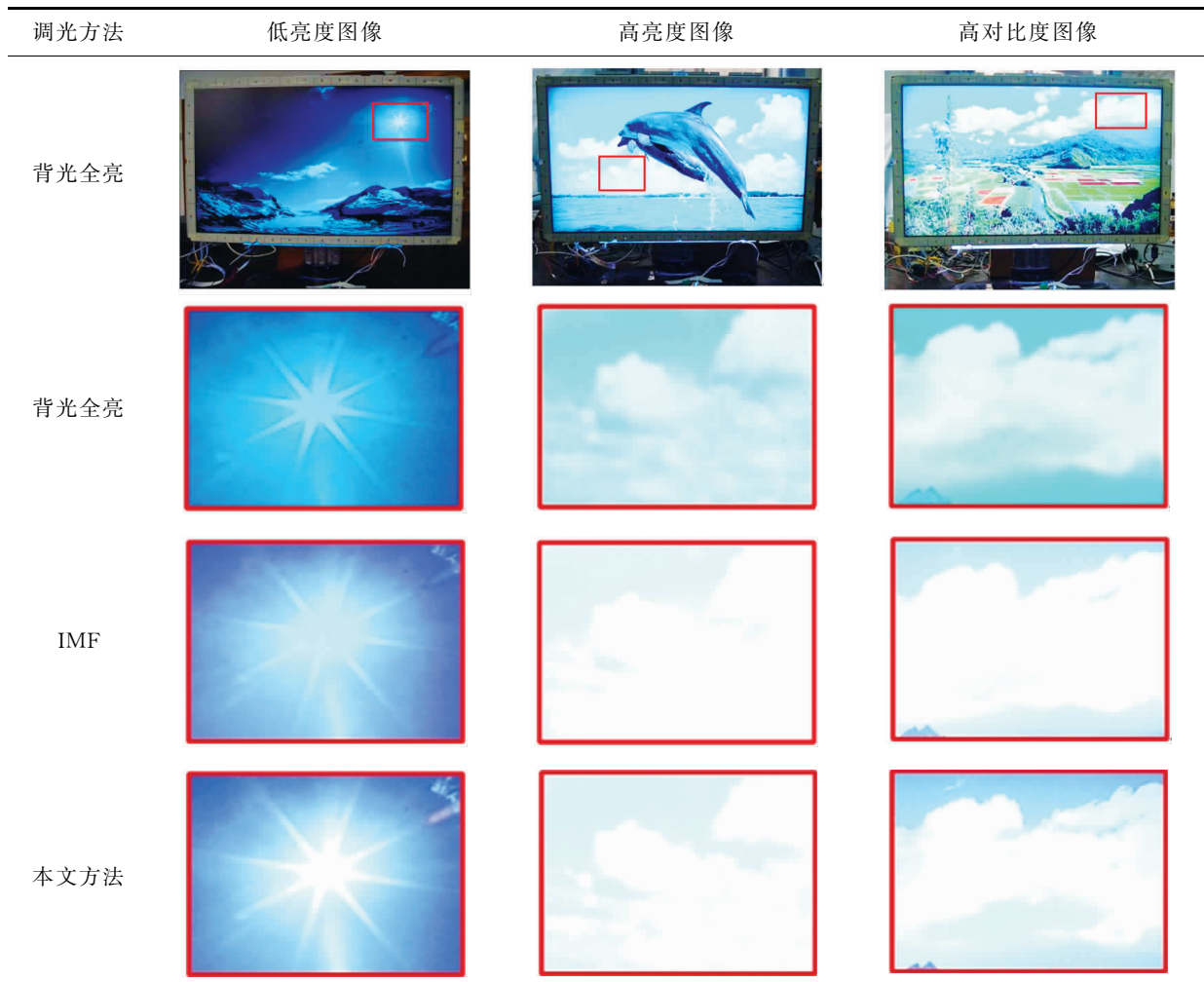
图 8 低亮度图像、高亮度图像和高对比度图像显示结果图。
