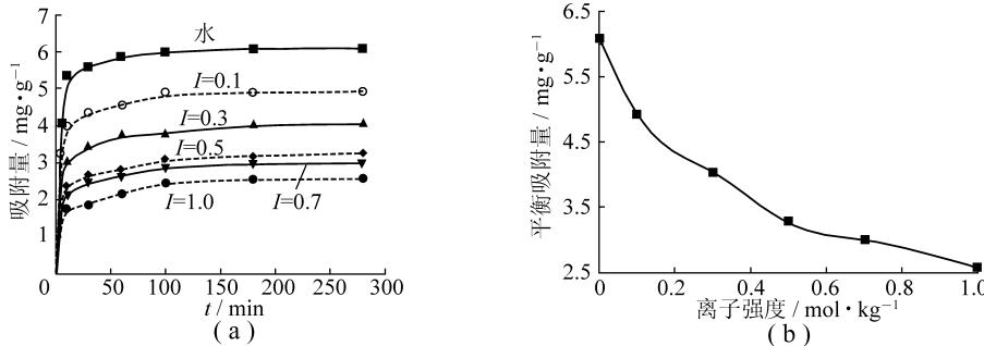
图 4 离子强度对吸附动力学和平衡吸附量的影响
