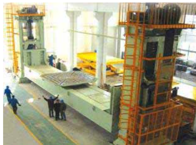
80 t双立柱升降式焊接变位机 无锡阳通机械设备有限公司
