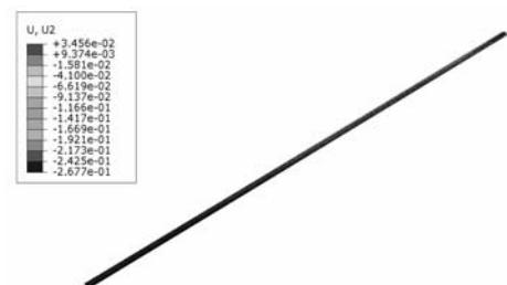
图14 等效壳单元热变形结果
