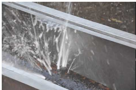
图8 2#筛管喷头停留处筛管出水情况
