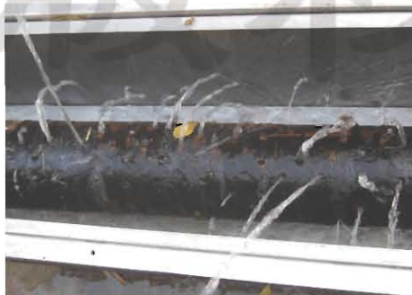
图 5 1# 筛管末端解堵后流动情况
