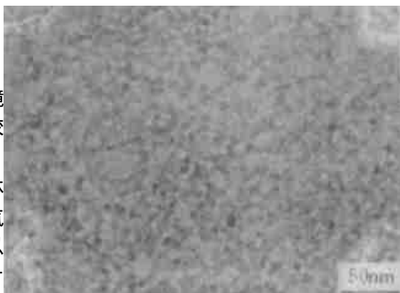
图 1 SiO 2 气凝胶的 TEM 照片
