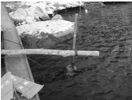
图 1 安装在测船上的 ADCP
