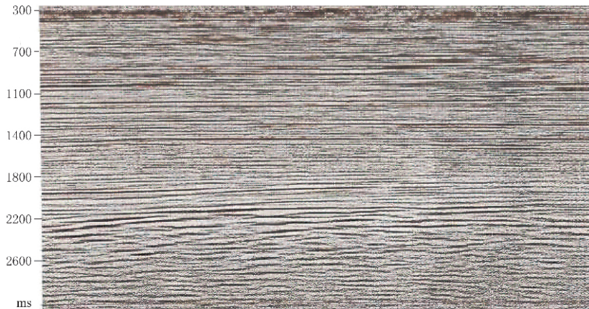
图 4 野外初叠典型剖面(反射波频率达 100~120Hz)
