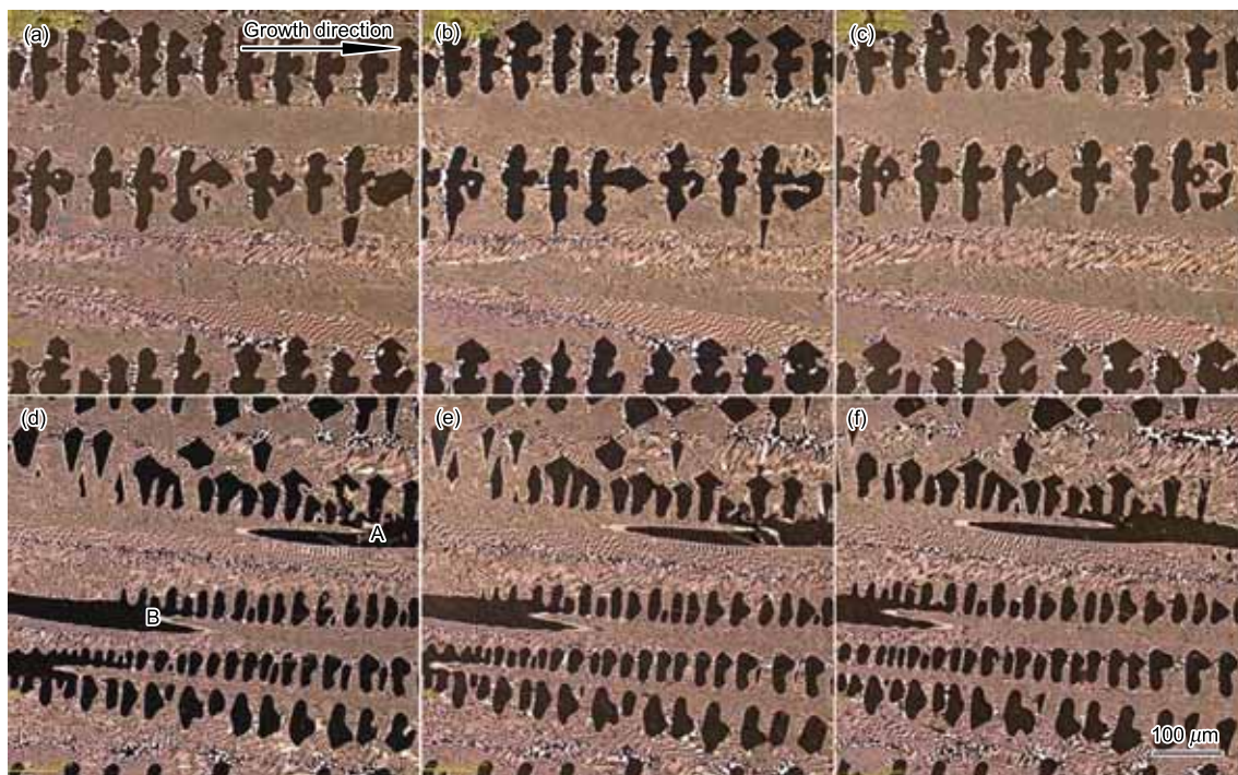
图 3 Cu-10.25%Mg 过共晶合金在 f_s=0.6 时不同层纵截面微观组织
