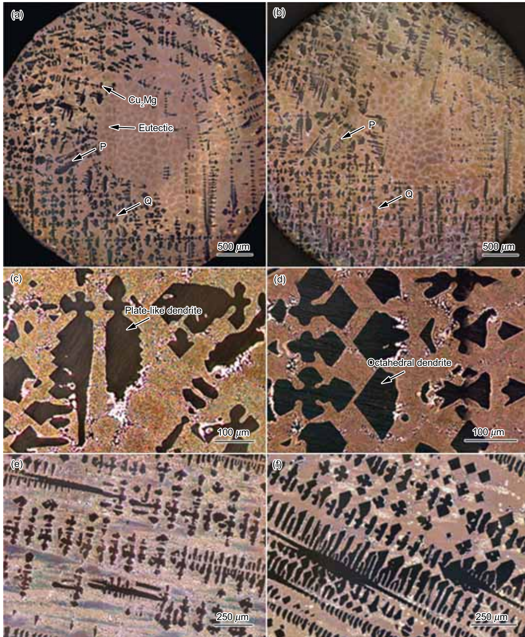
图 2 定向凝固 Cu-10.25%Mg 过共晶合金在不同凝固分数 ( f_s ) 下的组织
