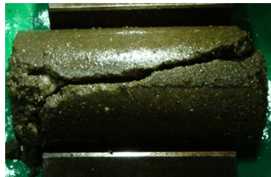
(b) 围压 45 MPa 标准渗流破坏照片
