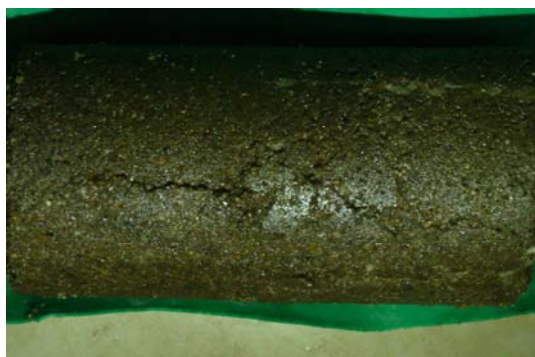
(b) 试样破坏裂纹
