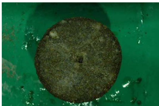
(a) 试样进水端受孔隙水压作用的破坏
