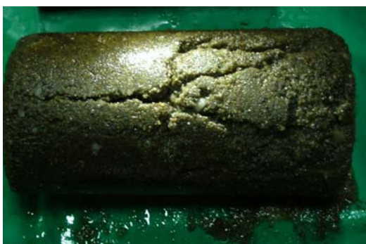
(a) 围压 15 MPa 标准渗流破坏照片
