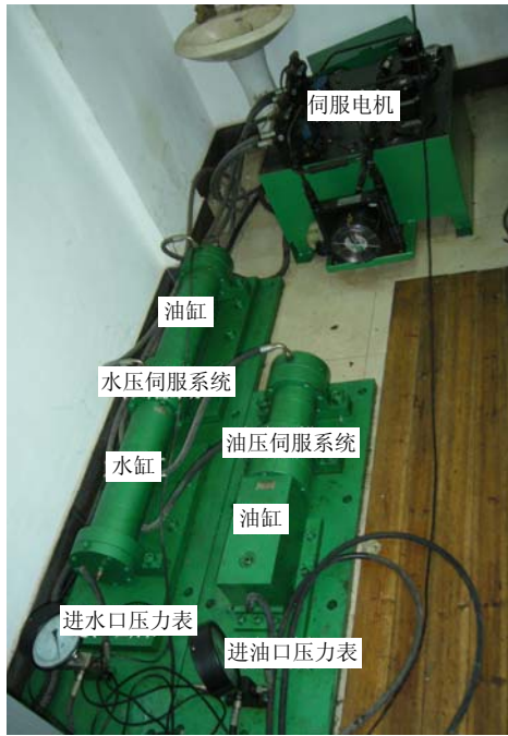
图2 水压及围压系统液压控制系统
