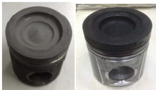
图 3 试验活塞实物图
