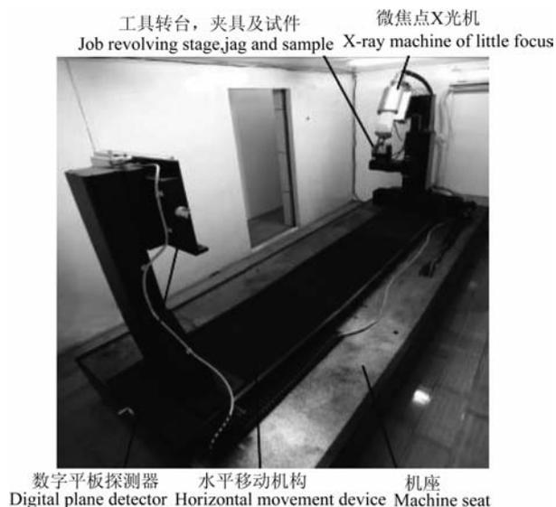
图 1  $\mu$ CT225kvFCB 型高精度显微 CT 试验系统
