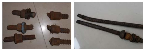
图 11 破断锚杆实物图
