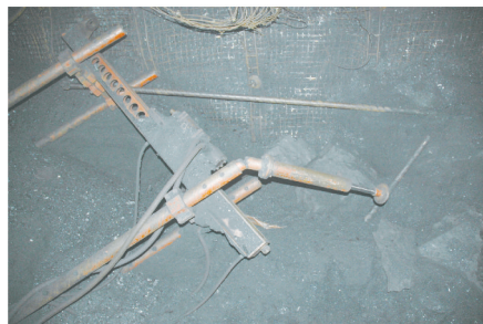
图2 井下被严重毁坏的钻机
