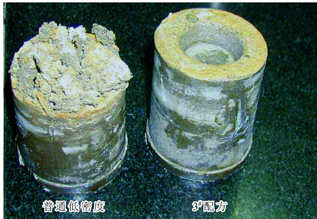
图3 不同水泥浆养护水泥石对比图
