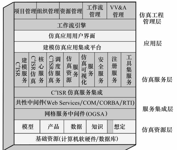
图 2 C<sup>4</sup>ISR 系统仿真应用集成体系结构
