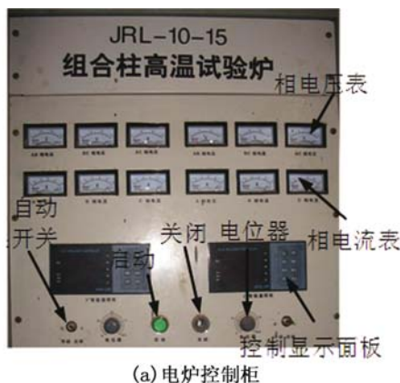
(①用于显示被控温度(PV);②用于显示输出百分比,监控温度或剩余时间(PV1)、负载电流值(PV2)、程序设定值(SV1);③状态指示灯;④键盘区)
