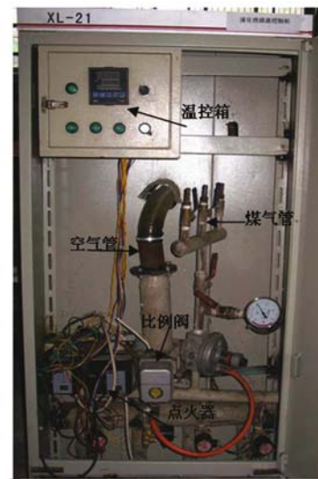
图 4 液化燃烧器的整体示意图 Fig. 4 Overall sketch of liquefied burner
