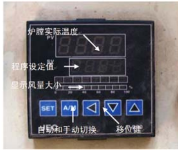
图 5 液化燃烧器温度控制器控制面板
