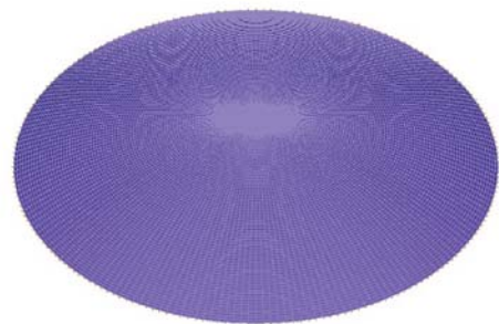
图 3 带肋拱顶储罐有限元分析网格图
