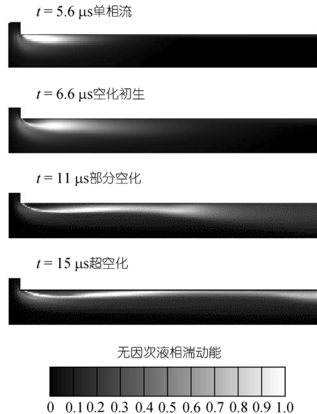
图5 喷孔内无因次液相湍动能布的演变( P_i = 70 \text{ MPa} )
