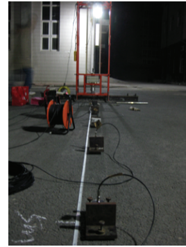
图 1 地表落锤试验
