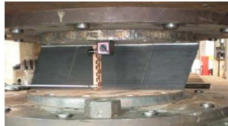
图 5 阻尼器大变形图片
