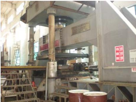
图 3 试验加载系统
