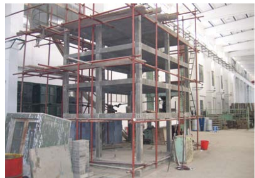
图 2 混凝土框架结构模型
